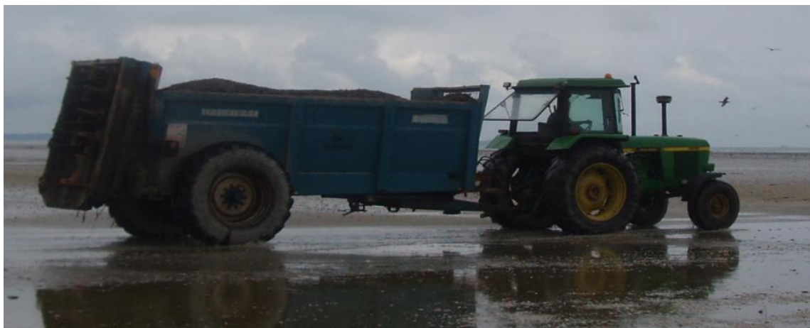
Figure 11 : Epandeur agricole prévu pour la pratique du dépôt de moules non commercialisables non commercialisables en Baie du Mont-Saint-Michel (Source : CRCBN)
